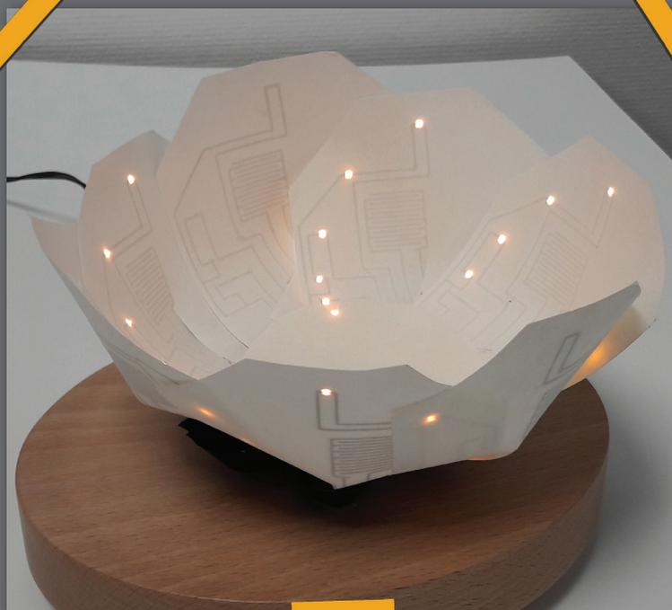
Le procédé d'impression et d'encapsulation de circuits électroniques dans une feuille de papier en cours de formation développé au LGP2 a permis la fabrication d'objets papier interactifs, connectés et principalement bio-sourcés (brevet Grenoble INP déposé). La fleur présentée contient des zones sensibles au toucher et au souffle permettant d'activer une animation lumineuse.
